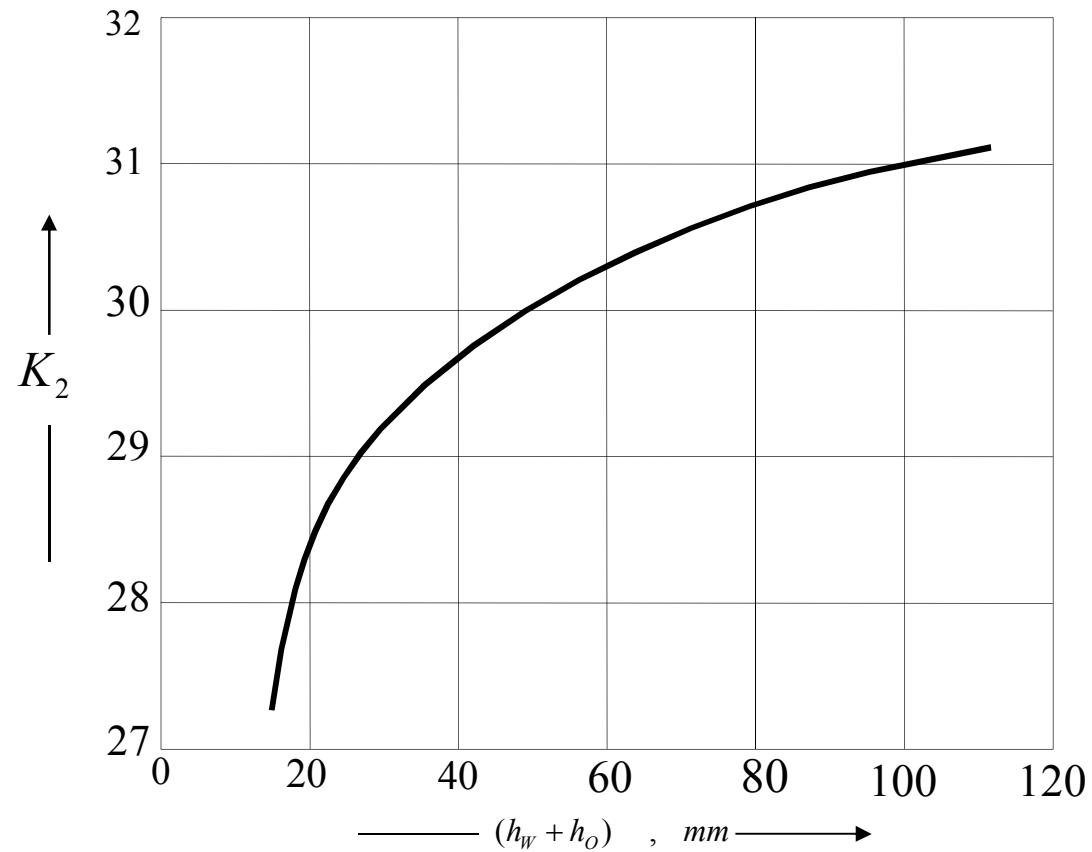
مقدار  $K_2$  در بررسی پدیده‌ی چکه کردن مایع از سوراخ‌ها
